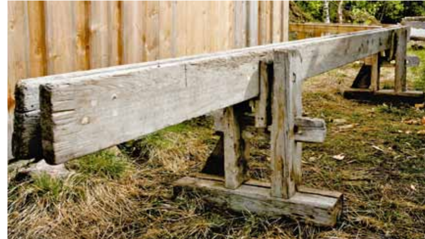
Skottbenk frå Kverndal i Målselv. Benken har hatt kilar for oppspenning av borda. Skottbenken er 29 norske tommar høg (1 norsk tomme er 26,15 mm). Foto: Siv K. Holmin.
